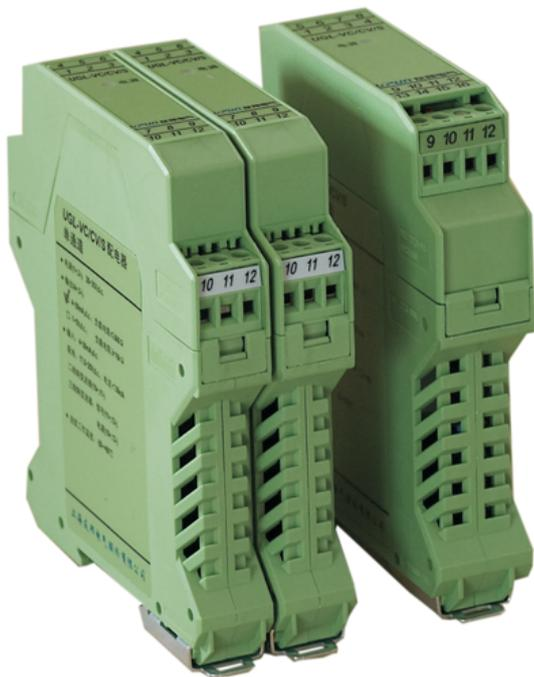
隔离器，输入电流(mA)：4~20mA，特征：回路供电，厚度17.5mm，高度114mm，颜色：绿色，通道数：2，安装方式：TH35-7.5、TH35-15
